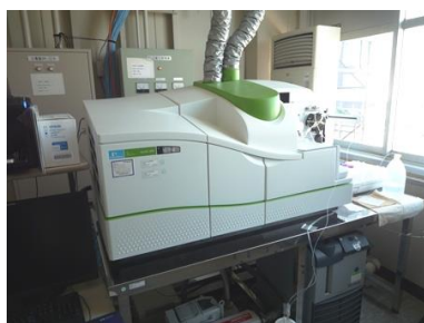
ICP質量分析装置 (ICP-MS) NexION 300 (Perkin Elmer)
