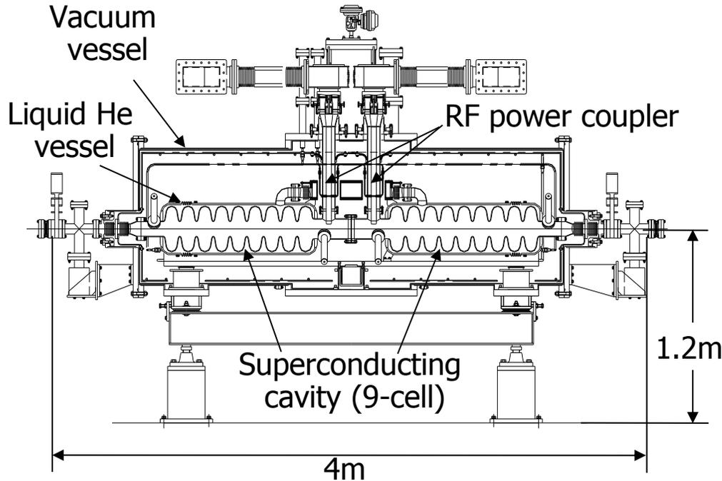
**972 MHz Cryomodule**
