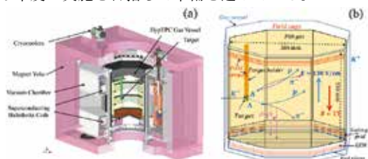
図 3 当グループが開発した H ダイバリオン探索実験用の (a) 崩壊粒子測定用磁気スペクトロメータ、および (b) その内部の飛跡検出器 (HypTPC) の概念図。
