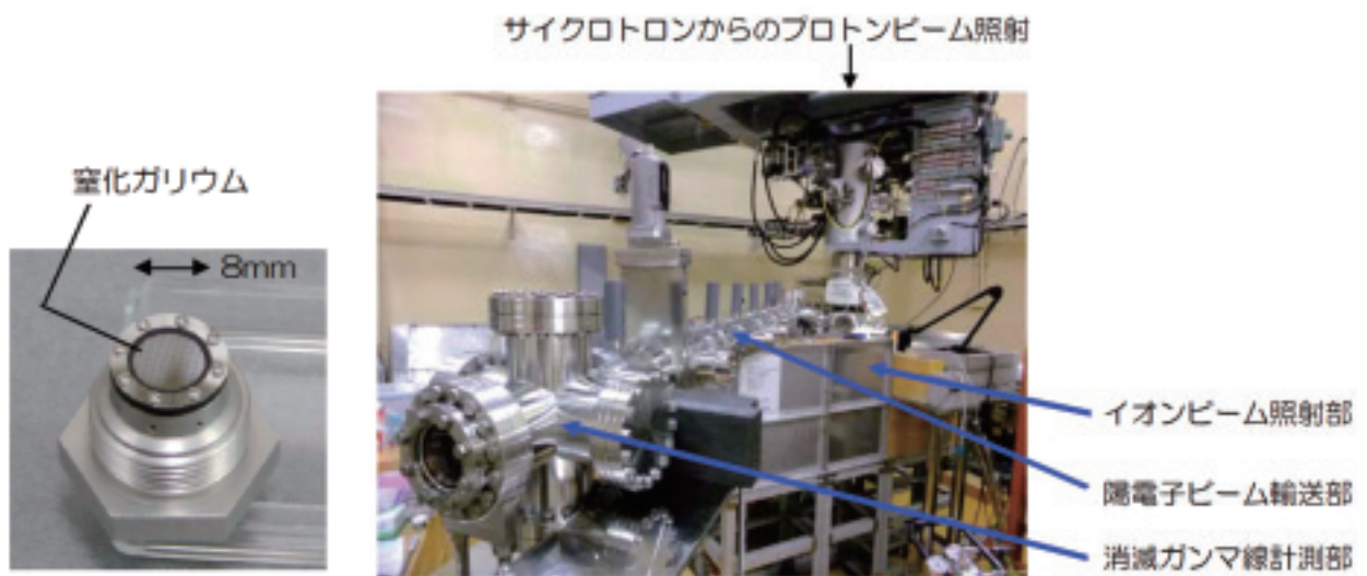
図2 ゲルマニウム68生成用の窒化ガリウム標的とスピン偏極陽電子ビーム発生装置
