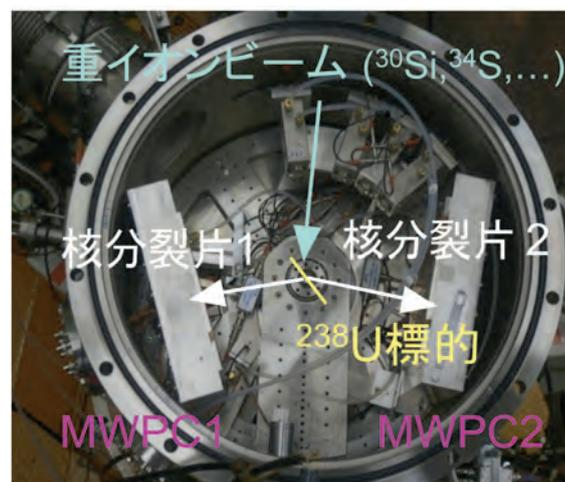
図3 タンデム加速器施設に設置した核分裂実験装置
