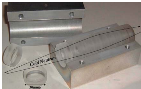
図2 両凹面状に削り出したフッ化マグネシウム屈折レンズ 70枚のレンズで冷中性子(波長6Å)を焦点距離10mに集光する。
