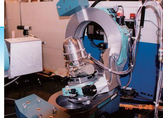
図 1 JRR-3 に設置された中性子 4 軸回折装置 FONDER [10]。
