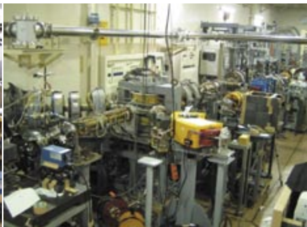
図1 超高時間分解能パルスラジオリシス装置 世界最高レベルの性能を持つ超高時間分解能パルスラジオリシス装置の1つとして評価されている。この装置には、超臨界水への放射線作用を観測する装置も併設されている。
