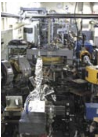
図1 超高時間分解能パルスラジオリシス装置 世界最高レベルの性能を持つ超高時間分解能パルスラジオリシス装置の1つとして評価されている。この装置には、超臨界水への放射線作用を観測する装置も併設されている。
