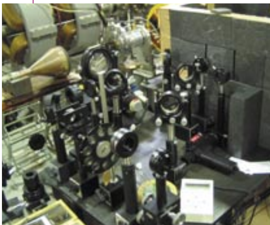
図1 超高時間分解能パルスラジオリシス装置 世界最高レベルの性能を持つ超高時間分解能パルスラジオリシス装置の1つとして評価されている。この装置には、超臨界水への放射線作用を観測する装置も併設されている。
