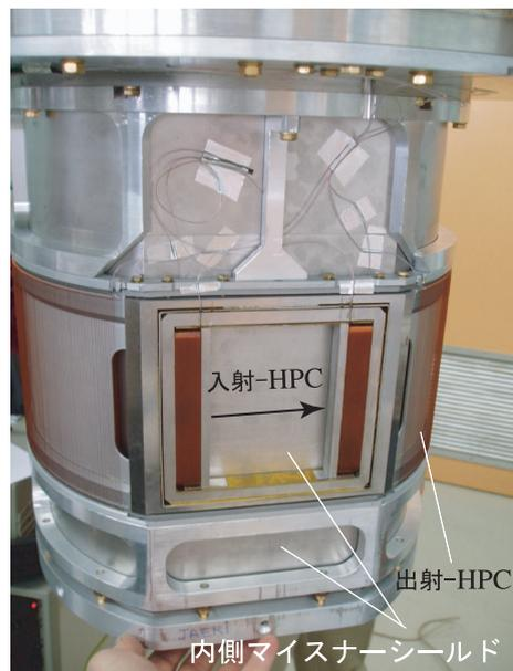
図1 外側の磁気シールドを外した状態の。スピンの方向を制御するためのハイブリッド歳差コイル(入射 と 出射 )と内側の磁気シールドが見えている。
