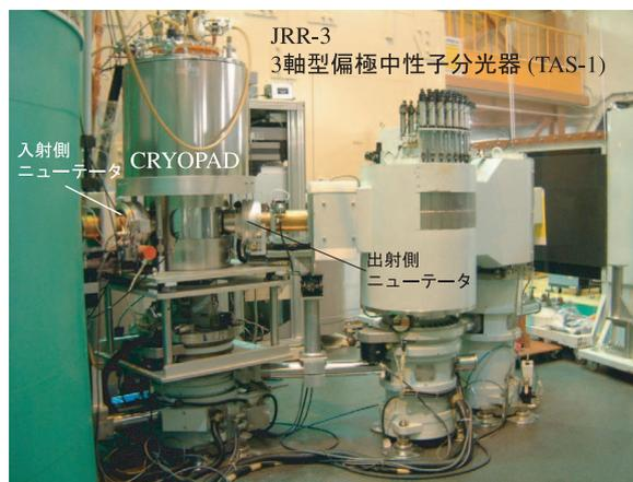
図3 3, 3軸型偏極中性子分光器( )での実験の様子。
