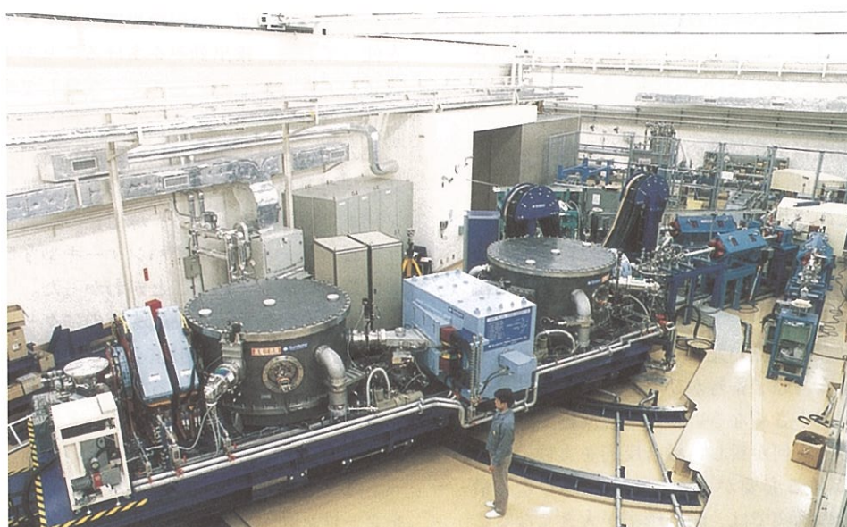
図2 タンデム加速器ブースター実験室に設置された反跳生成核分離装置。
