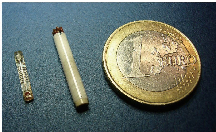
(左)無線信号 NMR 信号検出器のピックアップコイル (中)高速回転ローター (右)1 ユーロコイン Pickup coil for wireless NMR signal detector(left) High-speed rotating rotor (center) 1 Euro coin(right)
