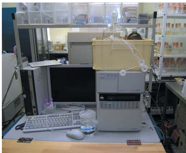
図3 ウランを集める膜タンパク質のデータ(左)と分析装置(液体クロマトグラフィー) 左図のウラン(オレンジの線)および膜タンパク質(青い線)は、ウランを吸着した酵母の膜タンパク質をカラムにより分子量の違いで分離した後に出したデータである。ウランのピークは、膜タンパク質の約13分後(分子量約10万)のピークと一致することから、ウランを濃集する分子量約10万のタンパク質が存在することが分かった。
