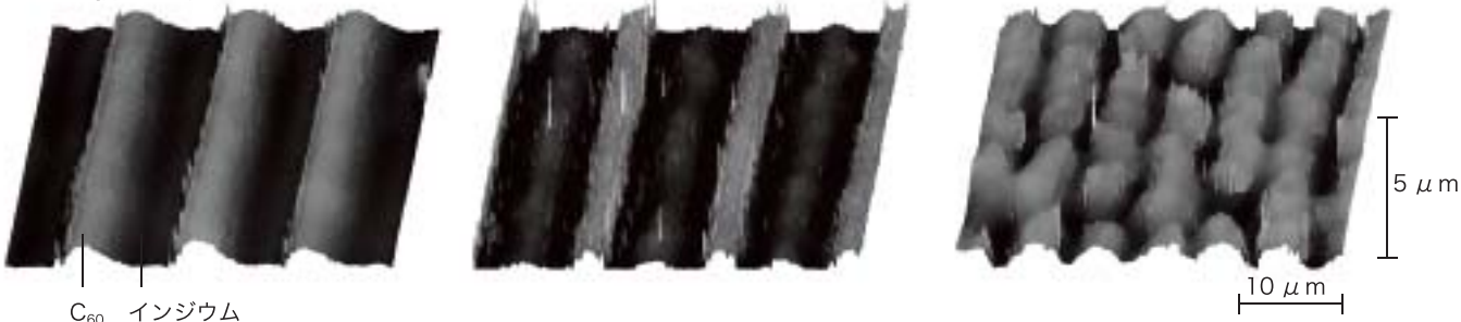
図3 C 60 とインジウムが交互に並んだしま模様 膜の組成などの条件を変えることで、さまざまな幅のしま模様ができる。
